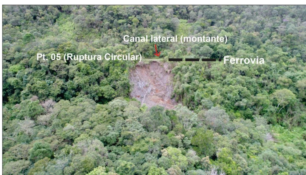
Figura 4.6 – Vista para a ruptura circular e seus principais elementos registrados no ponto 05 (imagem de drone cedida pelo SESC-OP).
