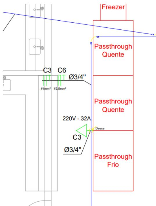
Conforme demonstrado na imagem acima (captura de tela retirada do projeto básico ao ANEXO V), atualmente no local contamos com 3 (três) passthroughs. O subitem 3.7 indica a substituição de dois circuitos já existentes de dois passthrough, um quente e um frio na qual serão substituídos somente os cabos como descrito no termo. Já o subitem 3.16 evidencia a infraestrutura para alimentar o terceiro passthrough.
